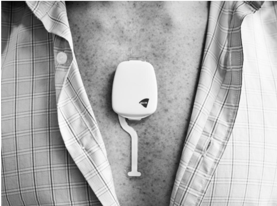
Figura 3.1: Dispositivo ePatch® ECG - (THORPE et al., 2014)
